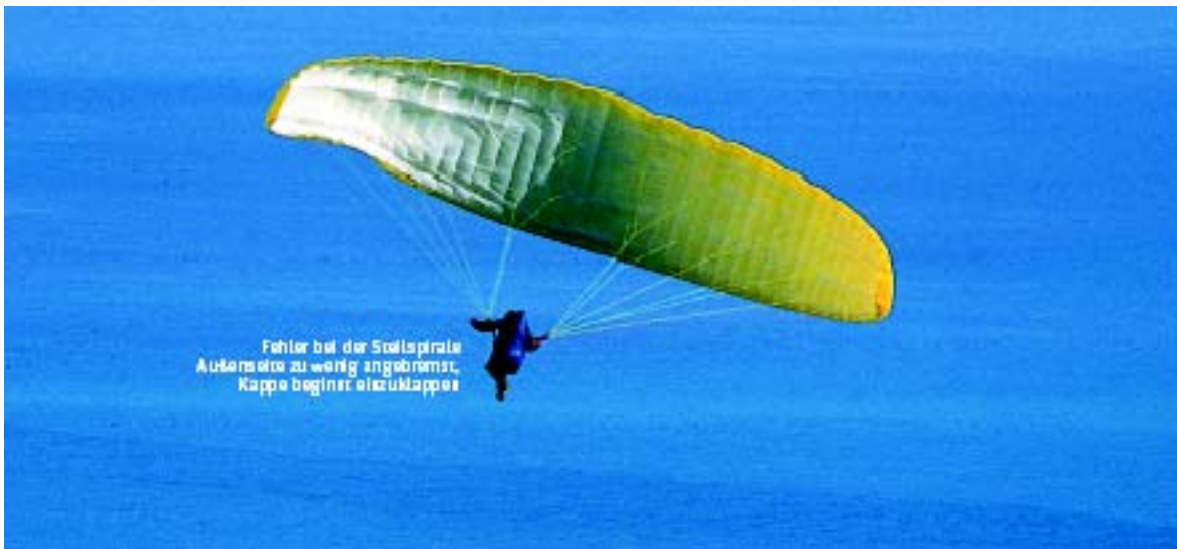
Figura 4: problema durante una discesa in spirale: troppo poco freno esterno, la vela inizia a crollare
